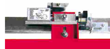
controlled speed limiter detail (VC) reduktor prędkości
