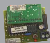
Odbiornik do pilota zdalnego sterowania (dostępny również w obudowie)
